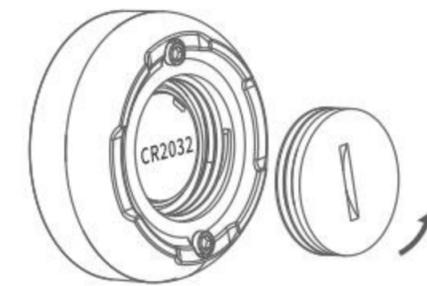
用薄片状工具(例如壹圆硬币)卡入电池盖槽，逆时针旋转打开电池盖；
