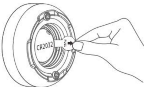
取出电池绝缘片，产品通电后旋紧电池盖。
